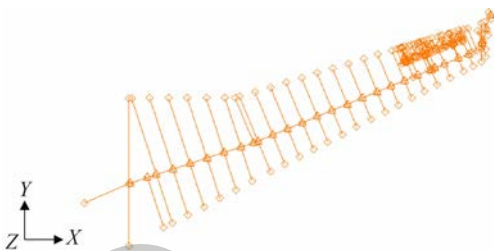
图 1 机翼梁架有限元模型 Fig. 1 Wing beam frame finite element model
